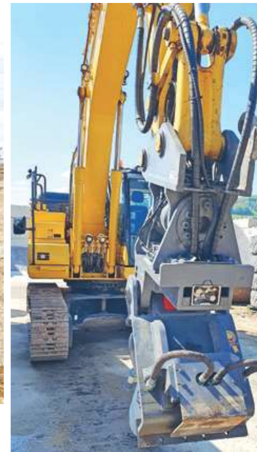
Für das Anfräsen bzw. nachträgliche säubern des Pfahlkopfes kommt eine kleine Frässcheibe zum Einsatz.
